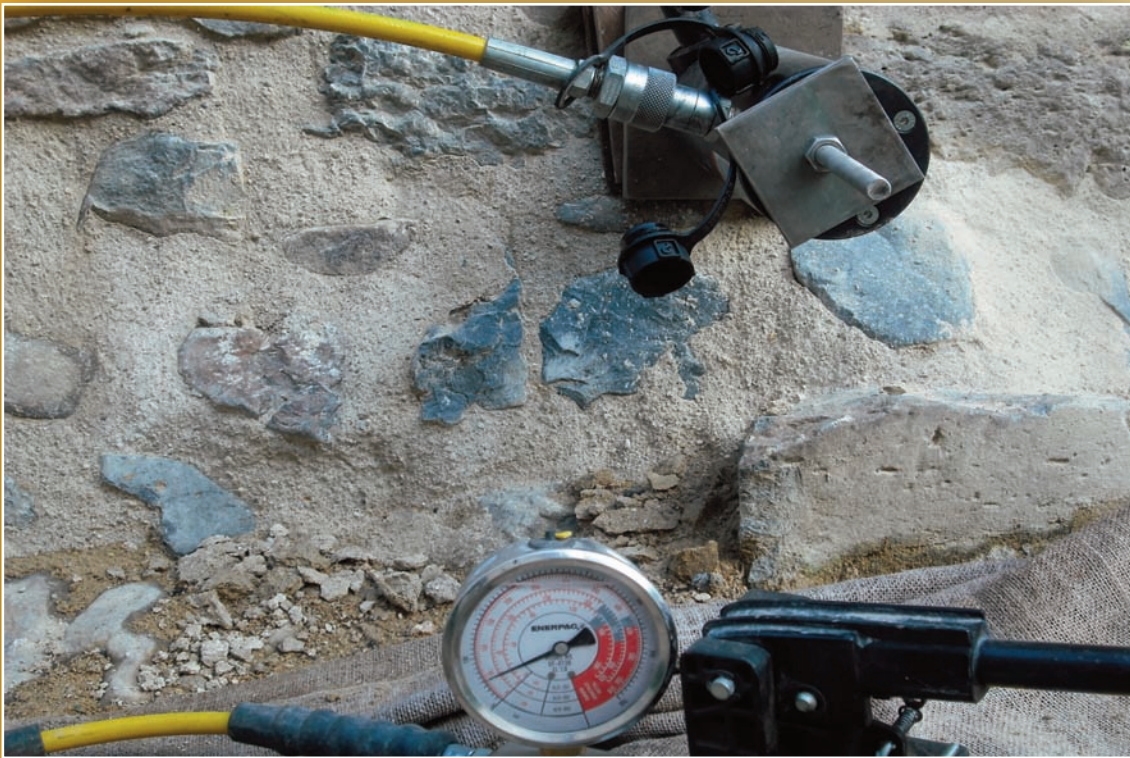
Ziehversuch an einem Nadelanker
